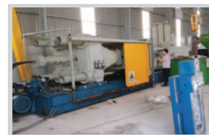
Máy đúc áp lực chế tạo ra vỏ đèn/ Pressure casting machine produces light cover
